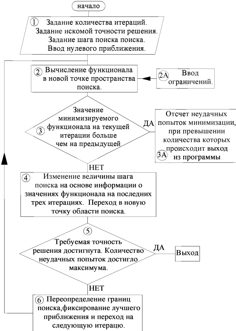
Рис. А1. Блок-схема алгоритма определения коэффициентов и степеней уравнения состояния методом случайного поиска с возвратом при неудачном шаге.
