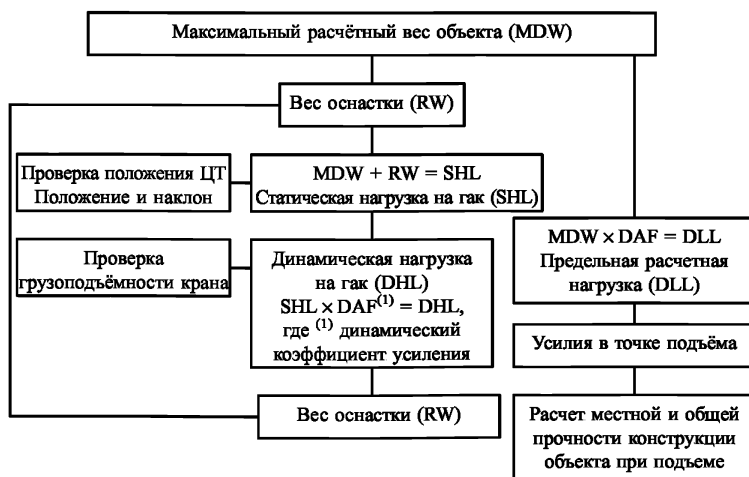
Рис. 3.3.2-1 Схема расчетов подъема объекта с использованием одного крана
