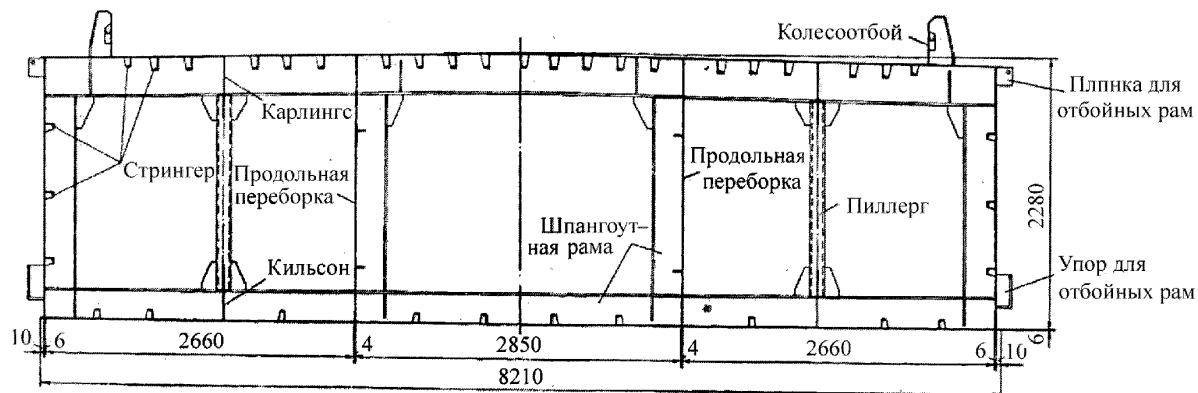
Рисунок Ж.4 – Поперечный разрез корпуса стального понтона плавучего причала
