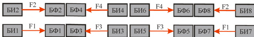
Рисунок 5.9. Схема организации горизонтального ИК барьера
