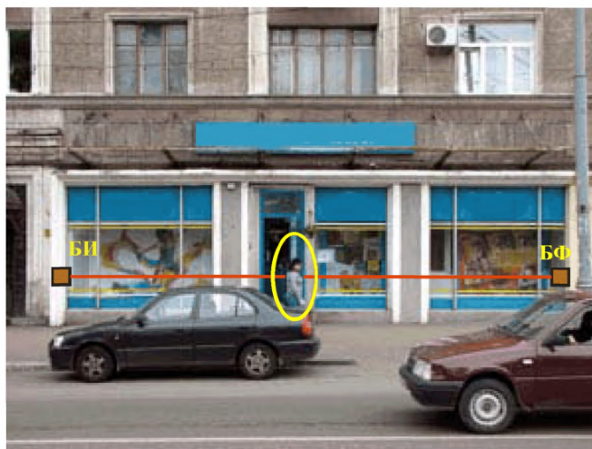
Рисунок 5.20 Не рекомендуемый вариант установки извещателя
