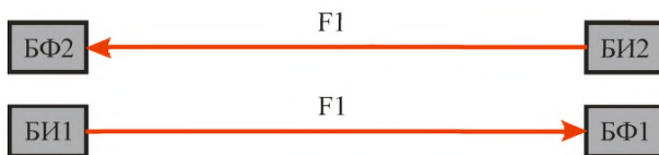
Рисунок 5.6. Схема организации двухлучевого ИК барьера из извещателей с одной рабочей частотой
