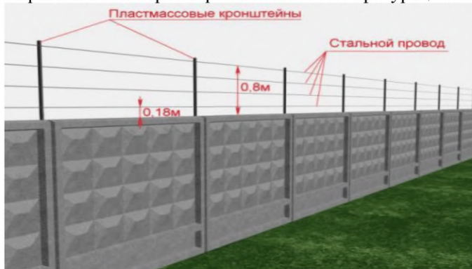
Рисунок 11. Установка ЧЭ на железобетонном заборе.
