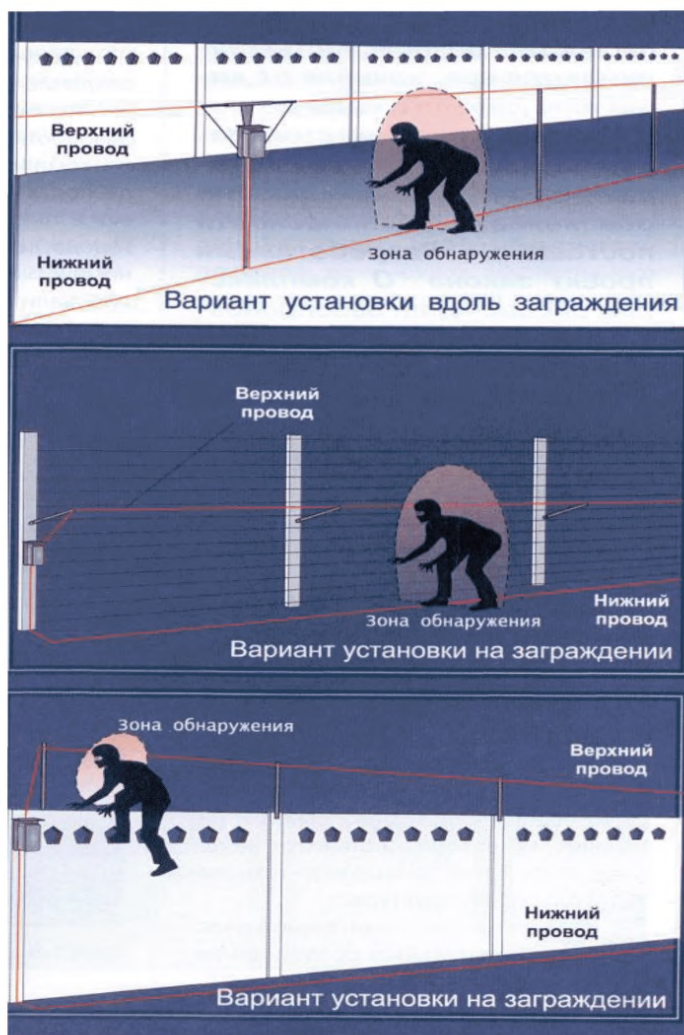
Рисунок 30. Варианты установки ЧЭ.
