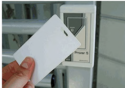
Рисунок 13. Карточка бесконтактная (Proximity).
