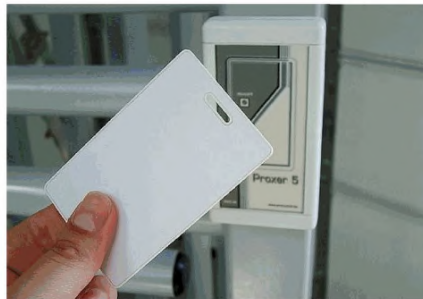
Рисунок 7. Карточка бесконтактная (Proximity).
