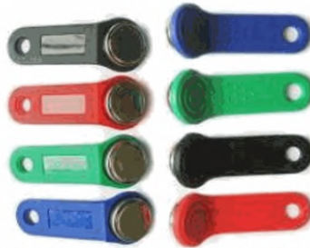
Рисунок 6. Электронные ключи TouchMemory.
