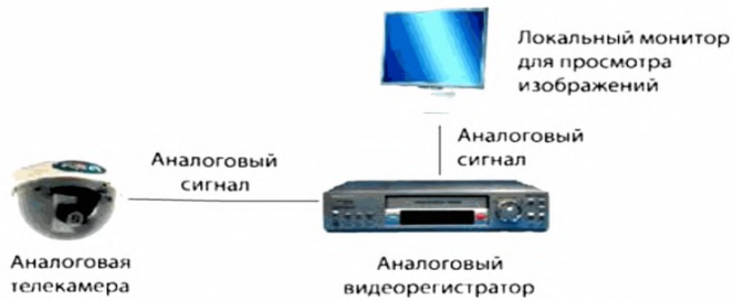
Рисунок 17. Аналоговая система видеонаблюдения.
