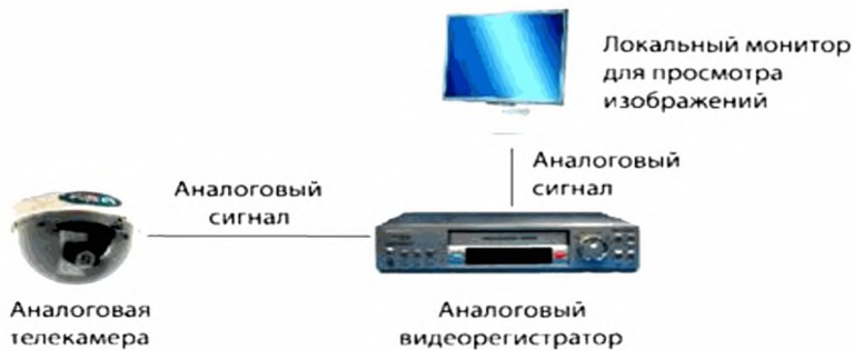
Рисунок 17. Аналоговая система видеонаблюдения.
