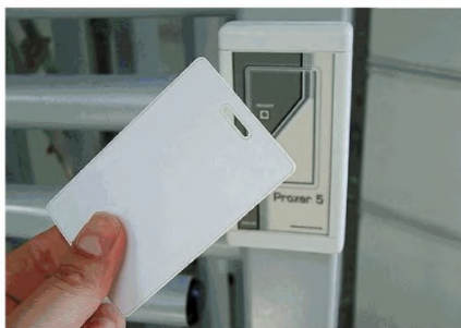
Рисунок 7. Карточка бесконтактная (Proximity).
