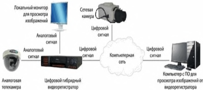
Рисунок 19. Структурная схема СОТ с применением цифрового гибридного видеорегистратора.
