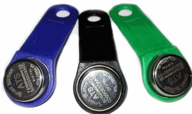
Рисунок 4.20 – Держатель ключа iButton, выполненный в виде брелока
