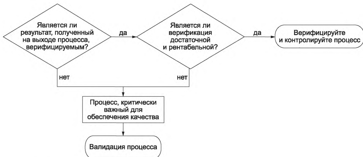
Рисунок В.2 — Дерево принятия решений для валидации процессов/процессов, критических для качества
