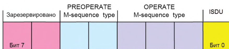
Рисунок В.3 — Параметр M-sequenceCapability
