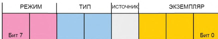
Рисунок А.25 — Структура описателя События
