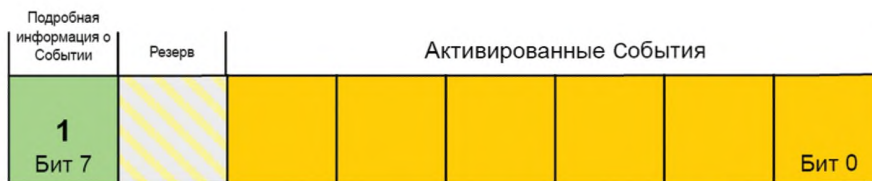
Рисунок А.23 — Структура Кода состояния типа 2
