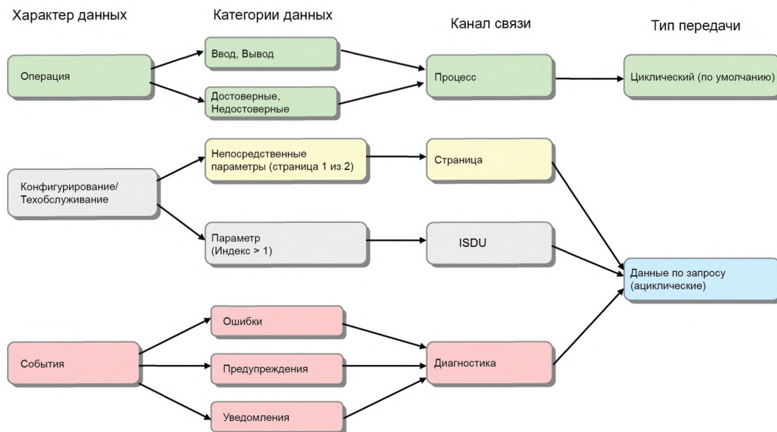
Рисунок 6 — Отношения между характеристиками данных и типами передачи
