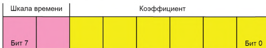
Рисунок В.7 — Структура параметра OffsetTime
