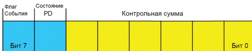
Рисунок А.3 — Октет контрольной суммы/состояния
