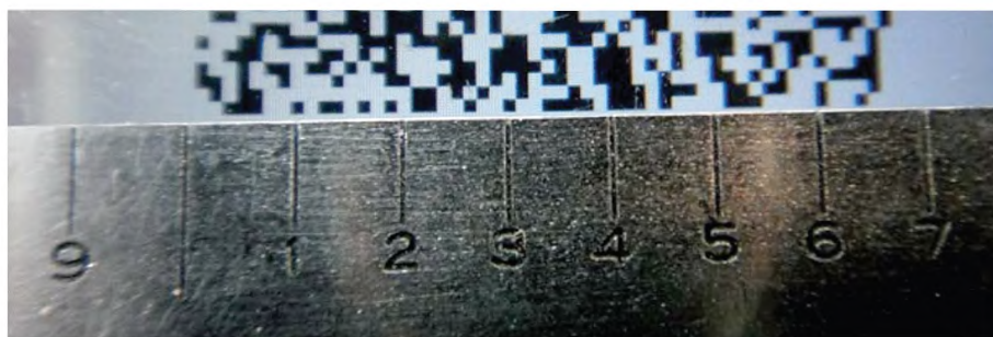
Рисунок 3 — Метод расчета размера Z двумерного символа на экране мобильного устройства
