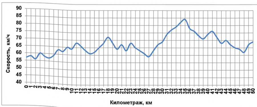
Рисунок 23 – Пример эпюры эксплуатационных скоростей движения
