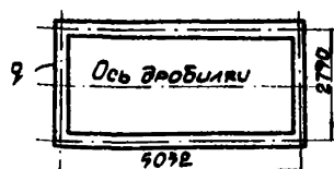
Рис.40. Схема распределения нагрузки на опорную раму от дробилки типа ДБ-28 ( q=28,8 кн/м)
