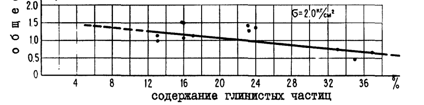
Б. Изменение сопротивления сдвигу намывных пород в зависимости от процентного содержания в них глинистых частиц.
