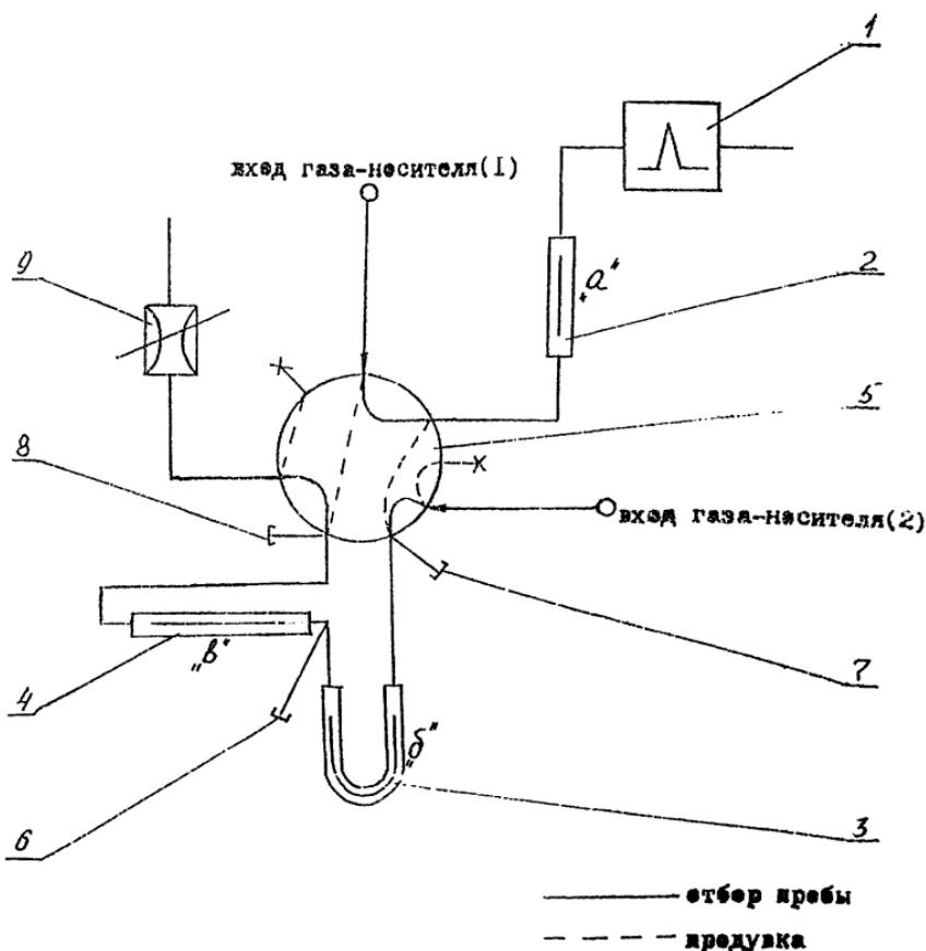
Рис.1 Схема соединения коленок.
