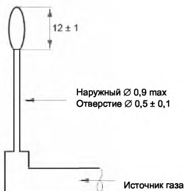
Рисунок 1а – Регулировка пламени
