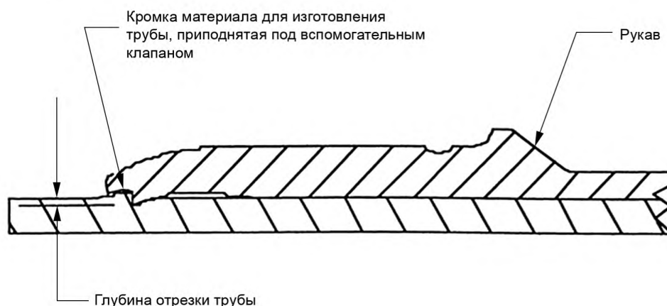
Рисунок 2 — Типовое захождение втулки с зубом в трубку
