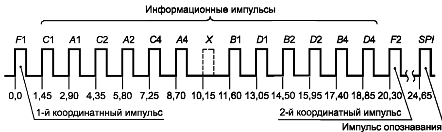
Рисунок 3 — Временная структура сигналов ответа режима RBS
