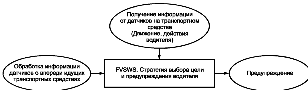
Рисунок 1 — Функциональные элементы системы предупреждения столкновений с движущимся впереди транспортным средством
