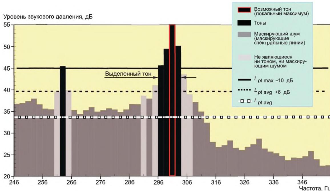
Рисунок 11 — Классификация всех спектральных линий критической полосы частот
