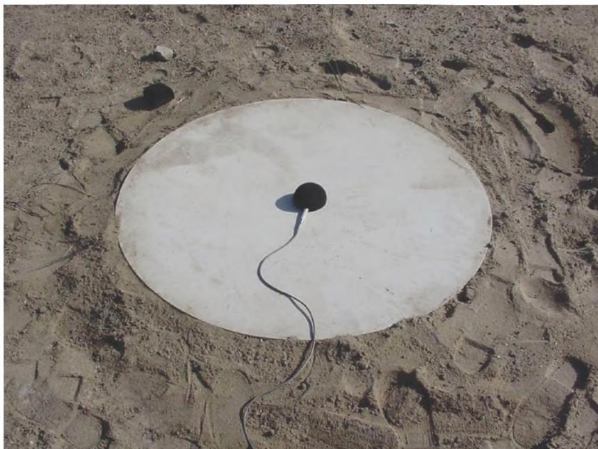
Рисунок 2 — Микрофон, установленный на измерительной панели
