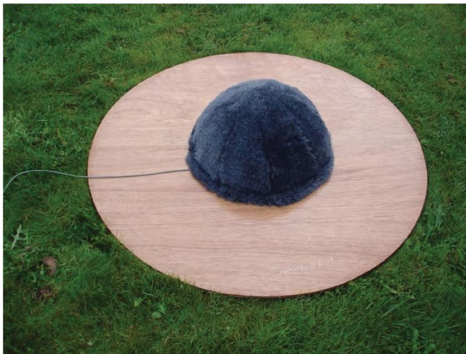
Рисунок С.2 — Дополнительный ветрозащитный экран (вариант 1)
