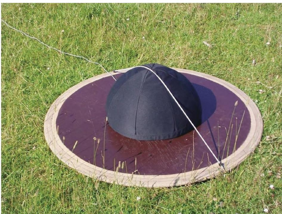
Рисунок С.3 — Дополнительный ветрозащитный экран (вариант 2)
