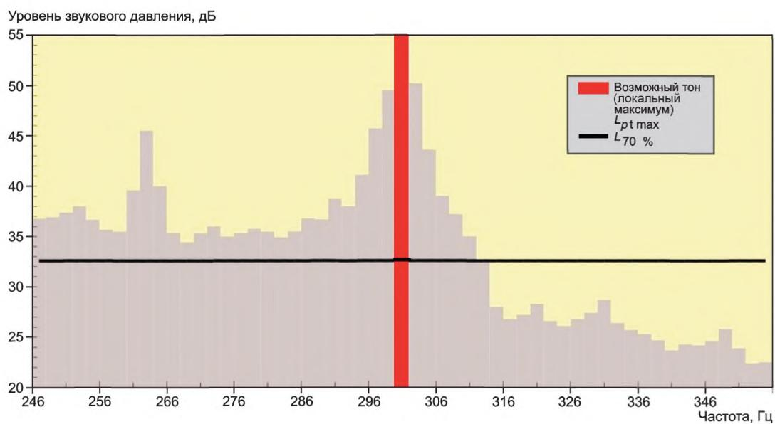
Рисунок 8 — Уровень  $L_{70\%}$  для одной критической полосы частот
