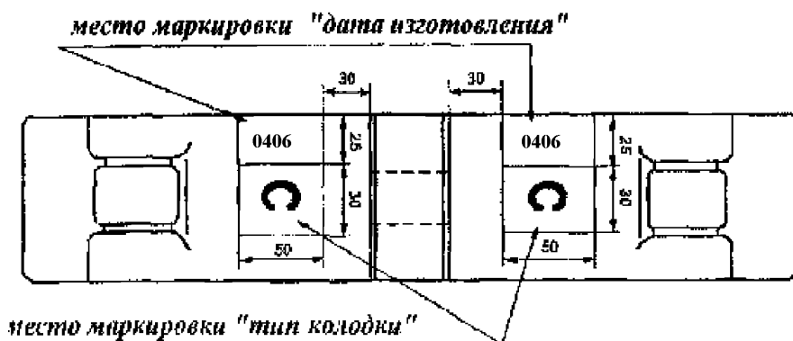
Рисунок 2 - Место расположения клейм «тип колодки» и «дата изготовления» для колодок без стальной спинки
