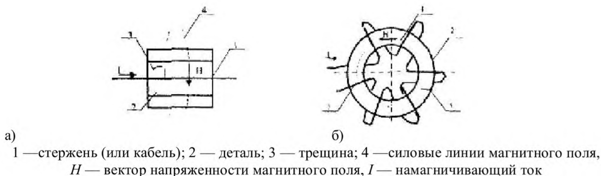
Рисунок 8.6 — Циркулярное намагничивание с помощью стержня (а) и гибкого кабеля (б) деталей, имеющих форму кольца
