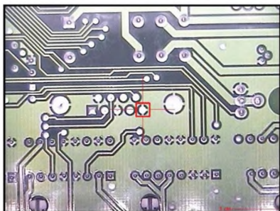
Рисунок В.5а — Участок из коллиматора диаметром 1,27 мм
