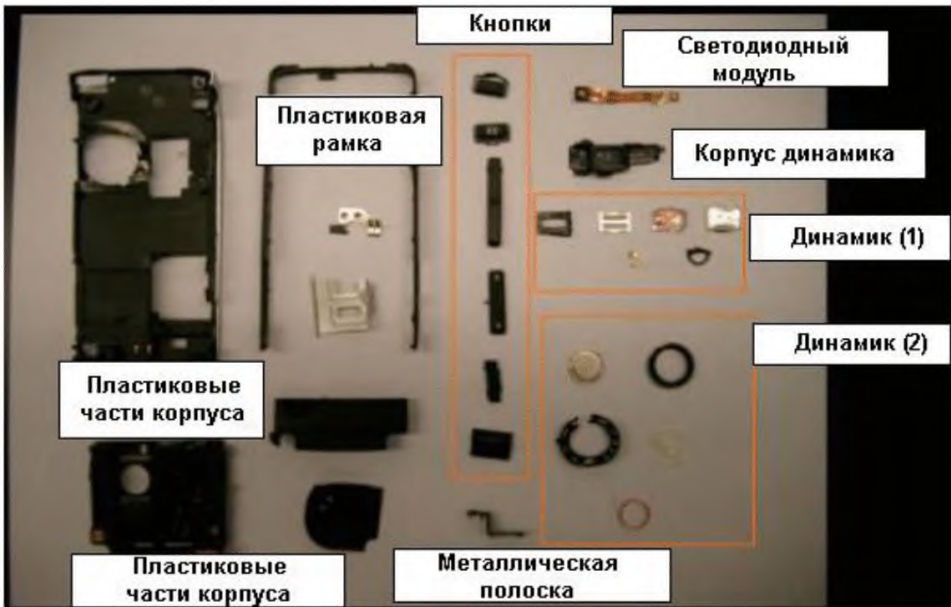
Рисунок Е.5 — Полная разборка нижней части корпуса
