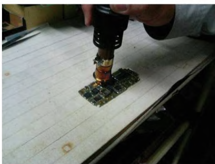
Рисунок D.1 — Тепловой пистолет для извлечения электронных компонентов
