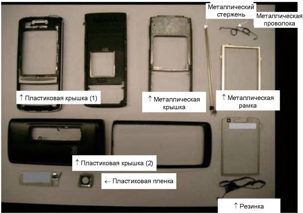
Рисунок Е.6 — Полная разборка остального корпуса/рамки
