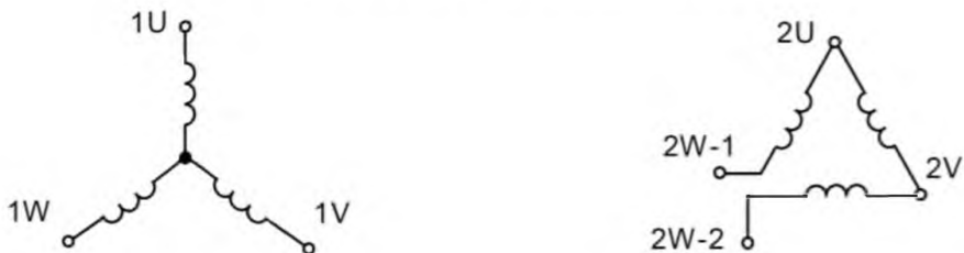
Рисунок А.15 – Постоянный крутящий момент, семь выводов
