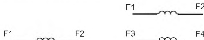
Рисунок 21 – Независимая обмотка возбуждения, один и два элемента
