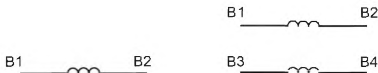
Рисунок 17 – Коммутационная обмотка, один и два элемента
