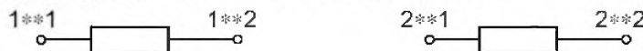
Рисунок 29 – Двухпроводные устройства (кроме типа R) L1 и L2 должны быть подключены в соответствии с письменными инструкциями или цветовым обозначением проводов
