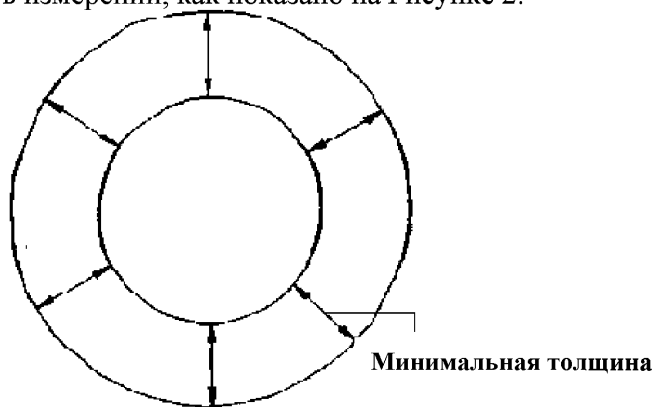
Рисунок 1 - Измерение толщины изоляции или оболочки (круглое внутреннее сечение)
