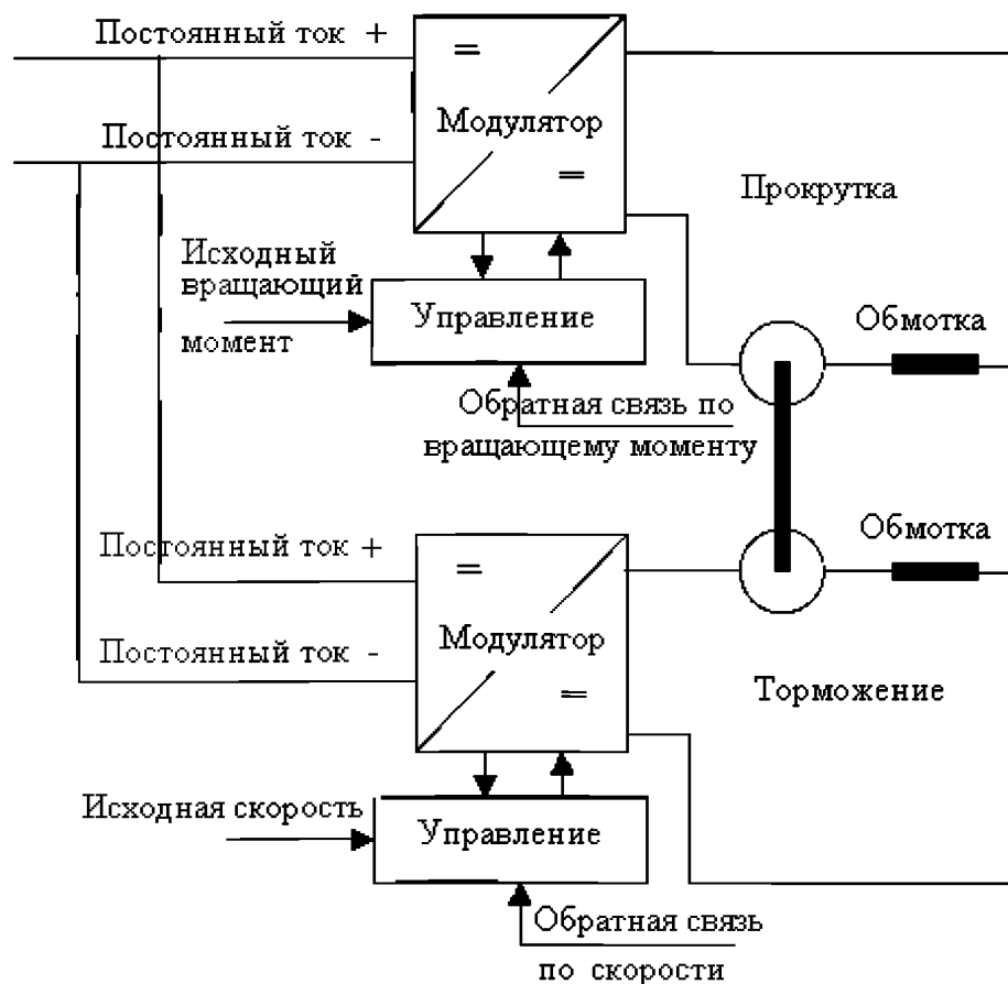
Рисунок 8 – Испытательная схема при испытаниях (электрических машин) методом взаимной нагрузки и электродвигателей постоянного тока комбинированной системы
