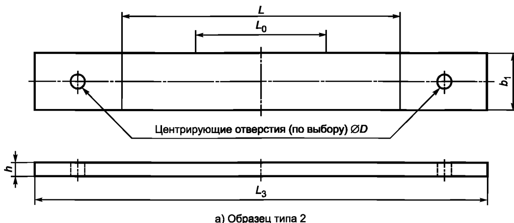
Рисунок 4, лист 1 — Образцы типов 2 и 3
