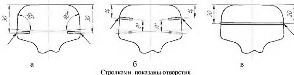
Рисунок И.3 - Расположение отражателей в головке образца
