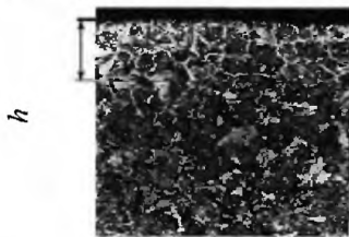
Рисунок 7 – Схема оценки глубины обезуглероженного слоя в головке рельса на травленном микрошлифе
