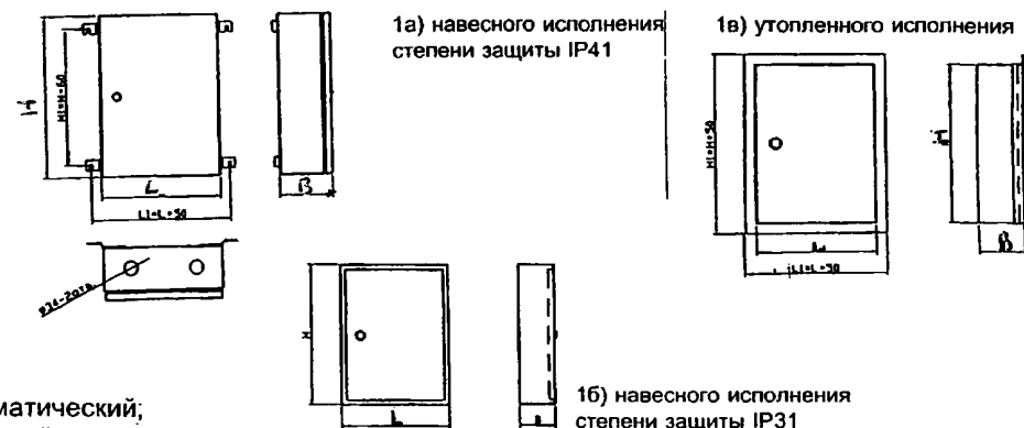
Рис.1 Общий вид, габаритные и установочные размеры щитков ОП,ОЩ,ОЩВ,УОЩВ
