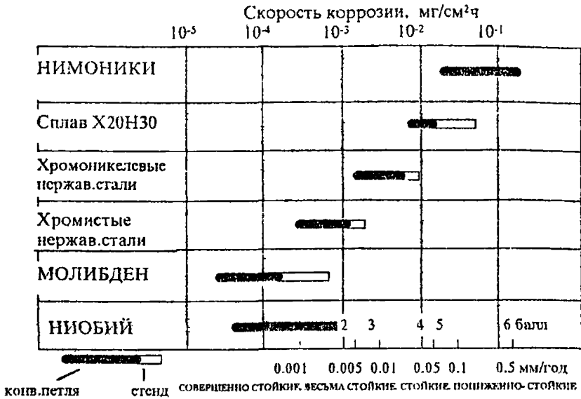
Рис. 8. Сравнительная диаграмма коррозионной стойкости конструкционных материалов различных классов в литии в неизотермических условиях. База испытаний 650°C, 1000 ч
