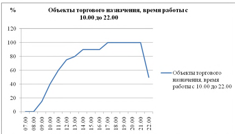
Рисунок 7.5 – Обобщенные графики загрузки стоянок у объектов торгового назначения, время работы с 10.00 до 22.00, для определения
