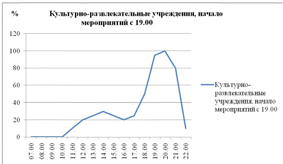
Рисунок 7.6 – Обобщенные графики загрузки стоянок у культурно-развлекательных учреждений, начало мероприятий с 19.00, для определения возможного снижения требуемого количества машино-мест без снижения обеспечения ими (в будний день недели)
