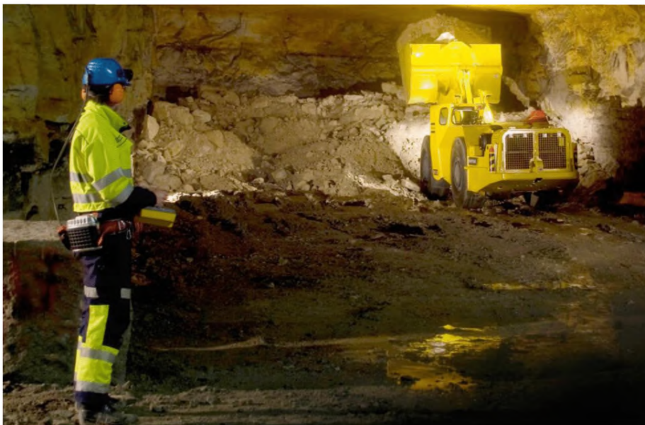
Рисунок 7.7 — Удаленное управление погрузочной машиной
