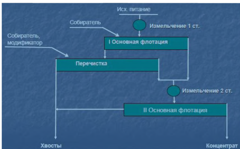
Рисунок 7.10 — Схема двухстадиального флотационного обогащения
