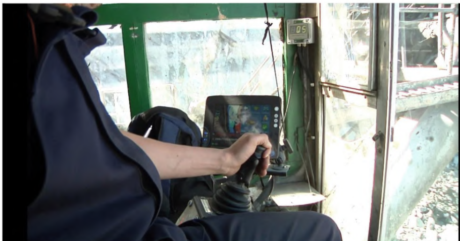
Рисунок 7.5 — Кабина экскаватора, оснащенная системой позиционирования ковша
