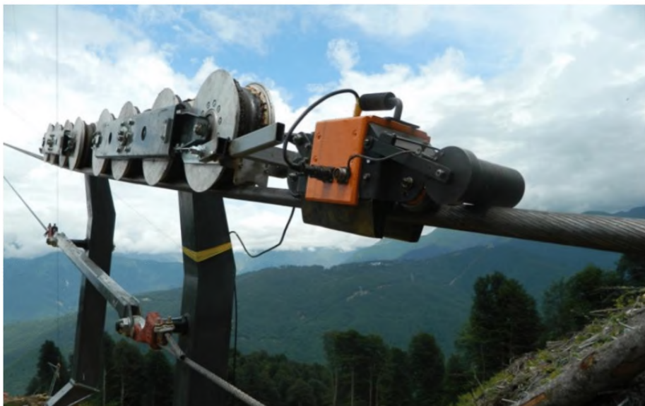
Рисунок 7.8 — Система автоматизированного мониторинга каната
