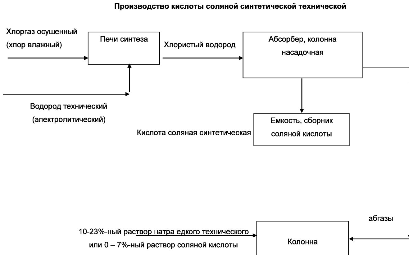
Рисунок 9.9 — Принципиальная схема производства кислоты соляной синтетической технической
