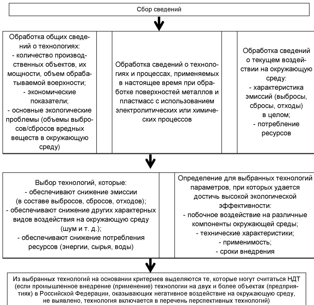
Рисунок 4.2 — Алгоритм выбора технологий в качестве НДТ, применяемых на двух и более объектах (предприятиях) в Российской Федерации, оказывающих негативное воздействие на окружающую среду
