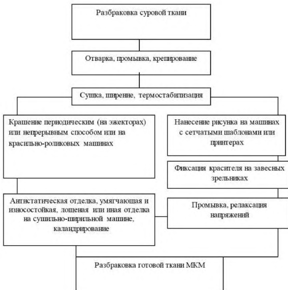
Рисунок 1.7 — Типовая технологическая схема для отделки шелковых тканей на основе химических нитей и волокон и их смесей с натуральными
