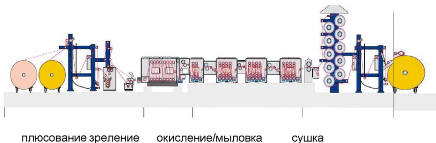
Рисунок 2.31 — Линия для крашения текстильных материалов по плюсовочно-запарному способу
