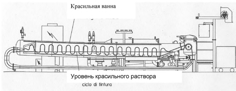
Рисунок 2.28 — Схема длиннотрубной красильной машины для высокотемпературного крашения
