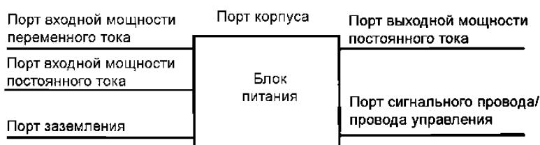
3.4.1 **порт корпуса** (enclosure port): Физическая граница прибора, через которую могут излучаться создаваемые прибором или проникать внешние электромагнитные поля.
