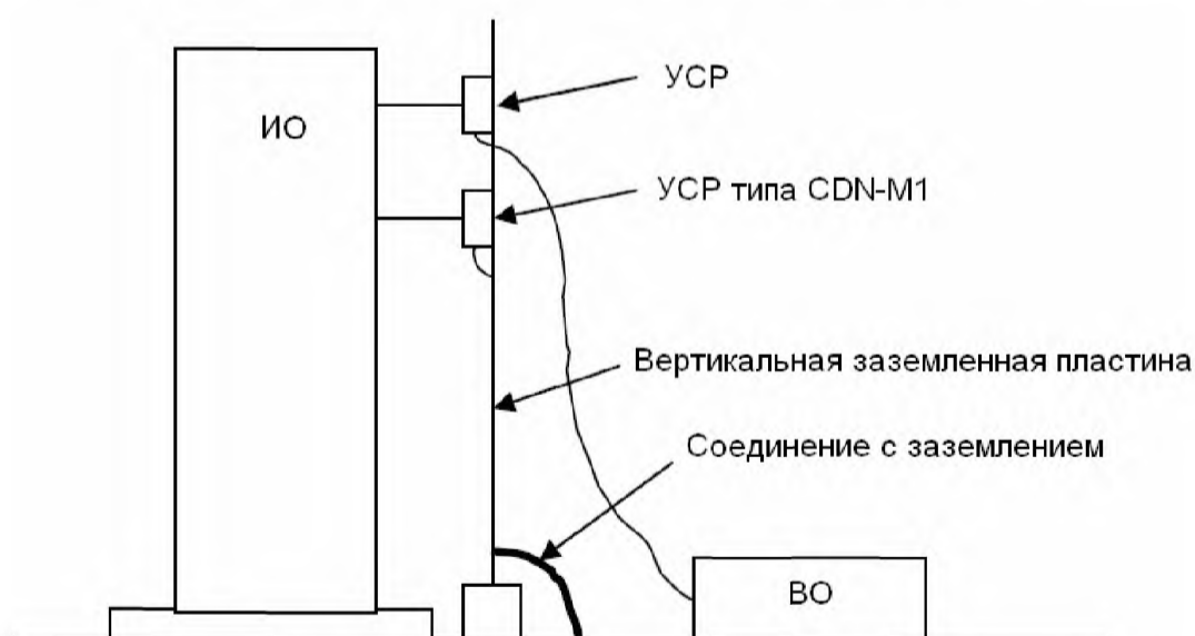
Рисунок F.2 – Пример организованного места для испытаний крупногабаритного оборудования с вертикальной эталонной пластиной заземления
