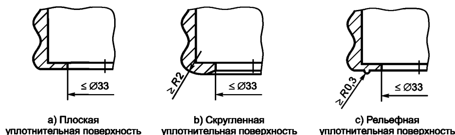
Рисунок 2 — Уплотнительная поверхность соединителя с наружной резьбой
