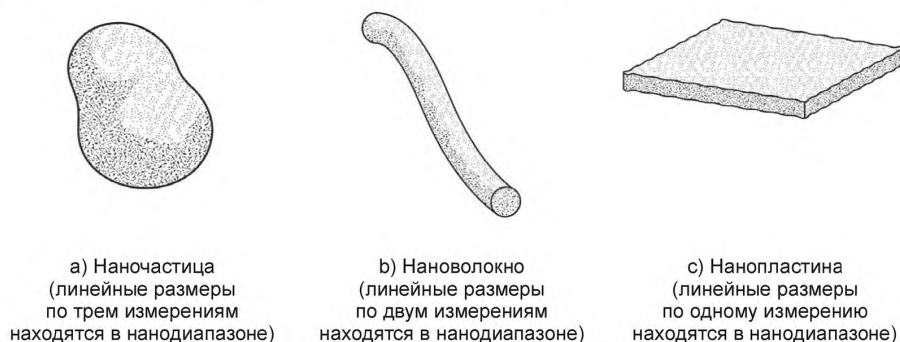
Рисунок 1 — Условные изображения форм трех основных нанобъектов, термины и определения которых установлены в настоящем стандарте
