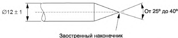
3б – Разрядный наконечник для контактного разряда
