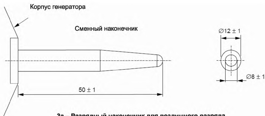
3а – Разрядный наконечник для воздушного разряда
