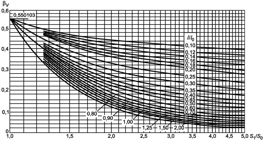
Рисунок К.3 — Коэффициент  $\beta_V$
