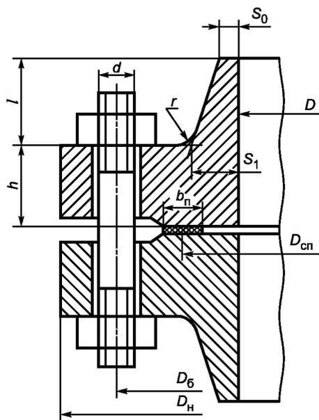
а — фланцевое соединение с гладкой уплотнительной поверхностью типа соединительный выступ
