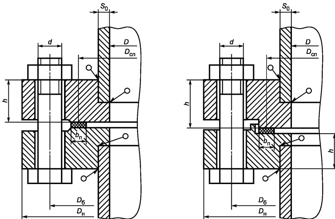
а — фланцевое соединение с гладкой уплотнительной поверхностью типа соединительный выступ
