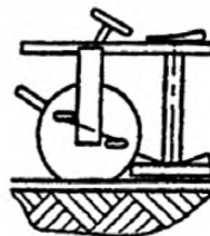
Рисунок 4 – Пример карусели типа D (движущейся по направляющим)
