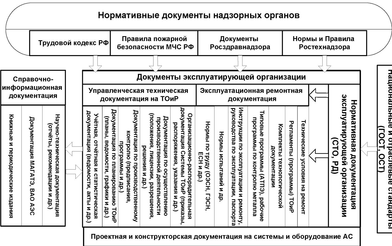
Рисунок 6.1 - Структура документации, составляющей информационное обеспечение ремонта систем и оборудования АС
