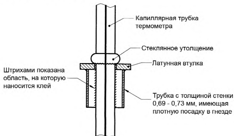
Рисунок В.1 – Расположение капиллярной трубки термометра во втулке
