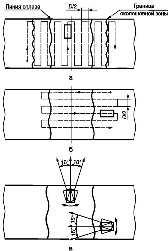
а — сканирование на поперечные несплошности; б — сканирование на продольные несплошности;
