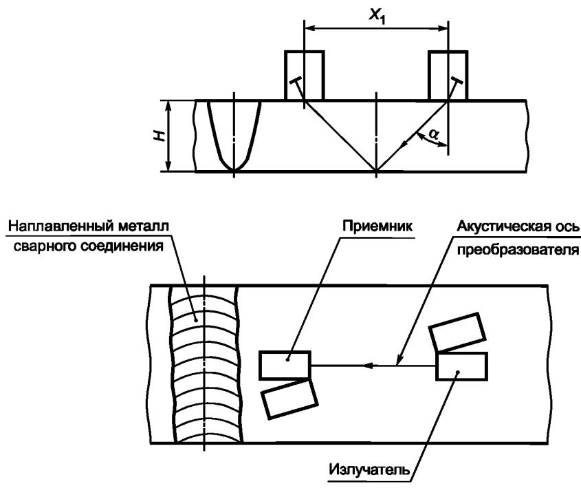
Рисунок А.2 — Схема расположения ПЭП на НО
