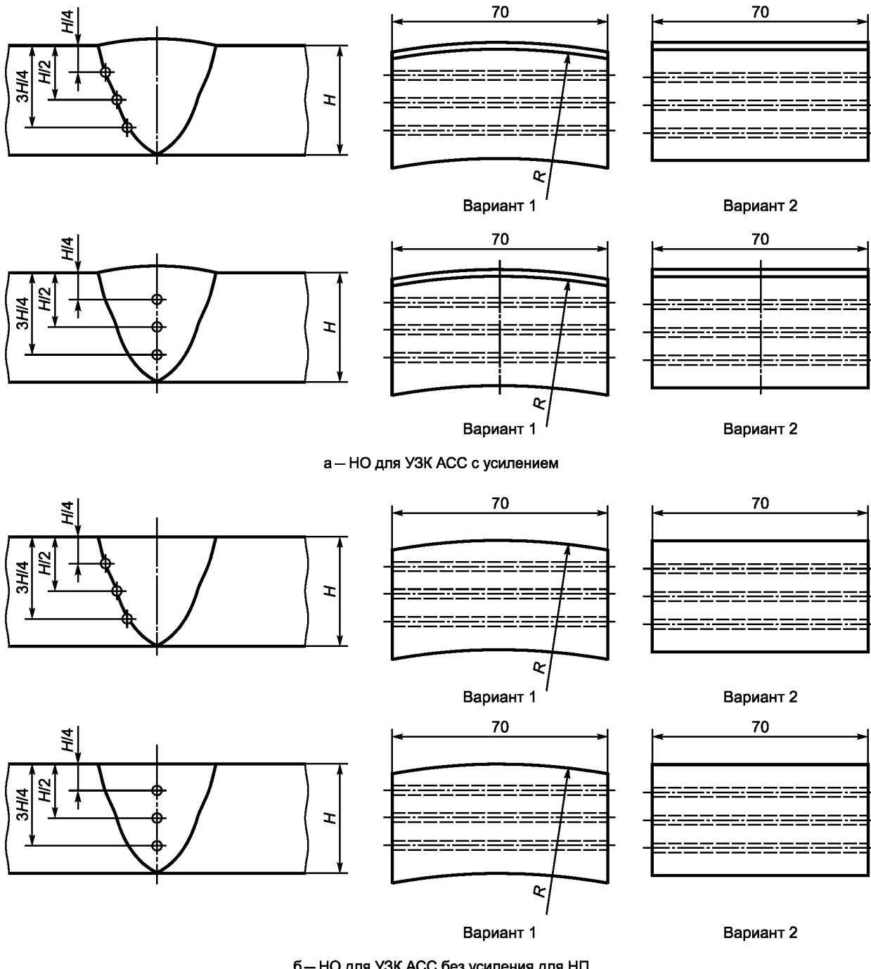
Рисунок 6, лист 1 — Пример комплекта настроочных образцов для УЗК АСС с номинальной толщиной стенки более 20,0 до 40,0 мм включительно: Вариант 1 — УЗК трубопроводов и ОК цилиндрической формы; Вариант 2 — УЗК листовых конструкций ОК
