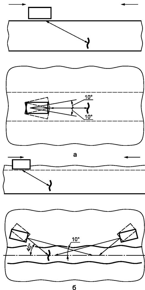
Рисунок 3 — Схемы УЗК стыковых АСС на поперечные несплошности
