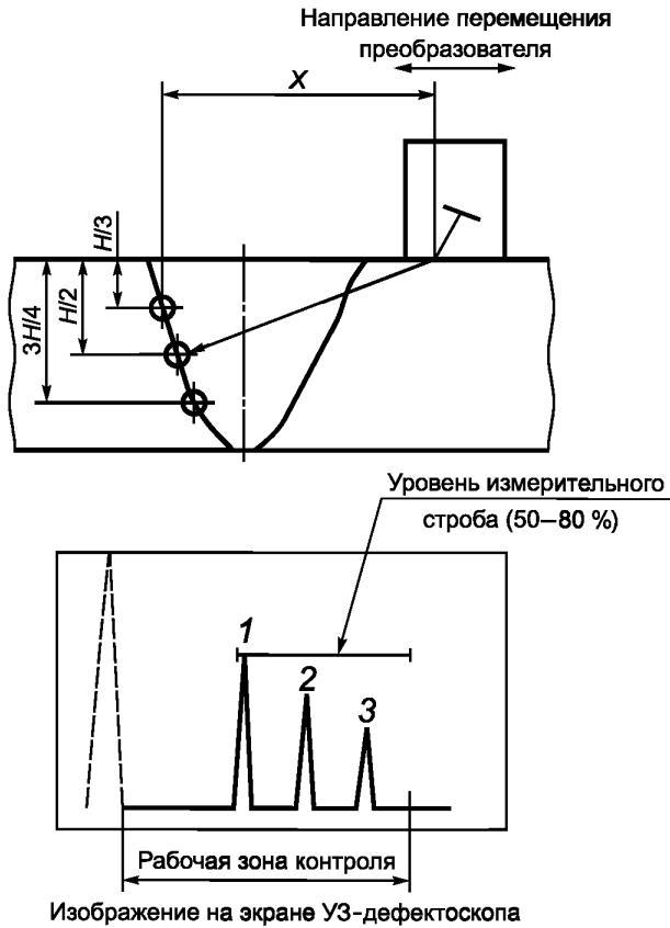
Рисунок 9 — Настройка диапазона развертки по БЦО
