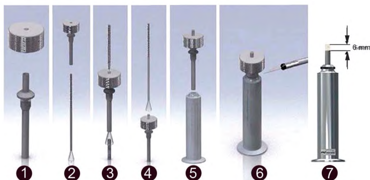
Рисунок 5 — Пошаговая установка фитиля
