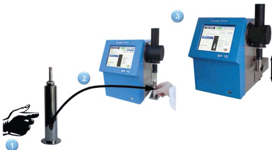
Рисунок 8 — Положение резервуара в автоматическом аппарате
