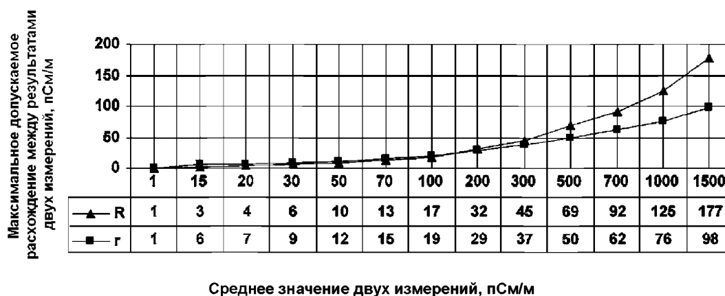
Рисунок 1 — Графическое отображение показателей прецизионности, приведенных в таблице 1
