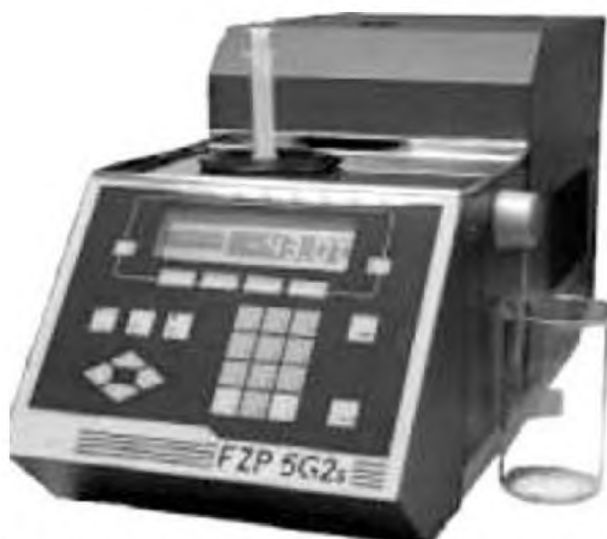
Рисунок А.1.4 - Автоматический прибор для определения температуры кристаллизации
