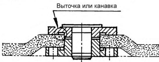
Рисунок 2 – Пример выточки или канавки на фланце
