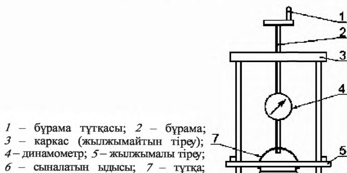
Б.1 суреті - Динамометр бойынша күшті өлшеуді бақылау арқылы ыдыс элементтерін беріктікке сынау арналған әмбебап құрылғылардың сызбанұсқасы
